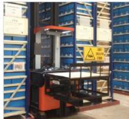
Entrepôt du CTLES à Marne la Vallée - Magasin de grande hauteur. Au 1er plan nacelle pour prélever des documents.
